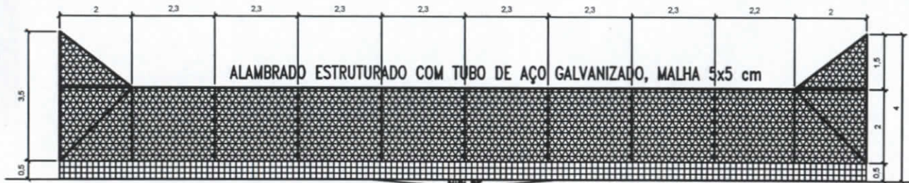
1 CORTE A-A (DETALHAMENTO DA ARQUITETURA) ESCALA INDEFINIDA
