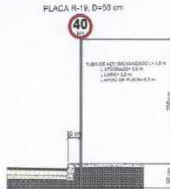
8 DETALHE DA PLACA DE VELOCIDADE MAXIMA (R-19, D=50cm) ESCALA (SEM ESCALA)
