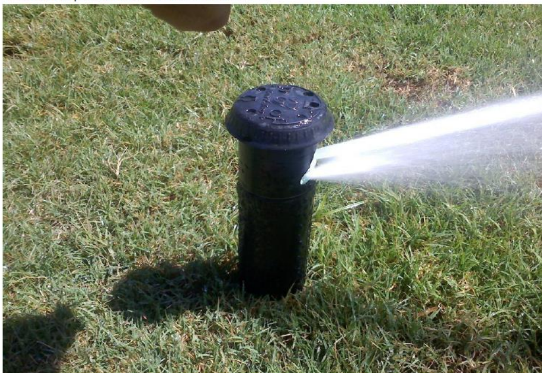
Fig. 5 – Rotor de Longo alcance em aço
